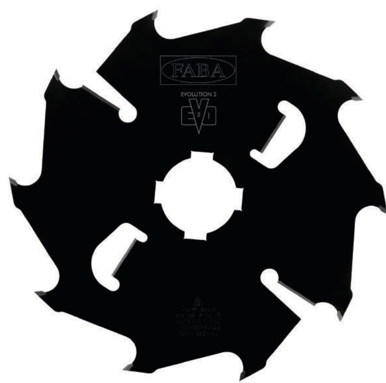
Piła PI-515 EVO2 do cięcia wzdłużnego drewna mokrego, miękkiego do wielopit o małych prędkościach posuwowych (do 10 m/min.) Fot. „FABA” S.A.
