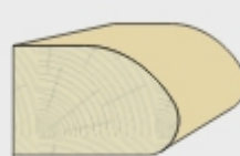
Przykład profilu do głowicy trzpieniowej GTS-01.02
