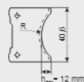
Przykład profilu do głowicy trzpieniowej GTS-01.01
