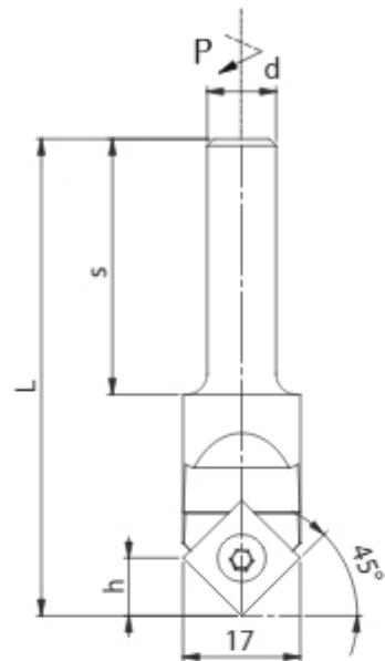
**FTS-11-B** – это концевая профильная фрезерная головка со сменными пластинами с количеством зубьев  $z=1$  предназначена для профессиональной обработки дерева и других древесных материалов, таких как ДСП, МДФ и других. Головка служит для выборки паза, а также для создания фасок в обрабатываемом материале.
