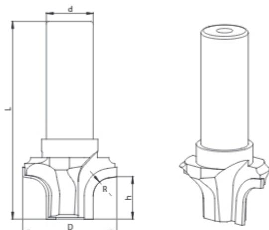
Фрезы концевые профильные тип **TPD-20** правые или левые предназначены для профилирования на цифровых станках с ЧПУ.
