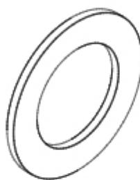
Прокладка **PD-01** повышенной твердости, предназначена для фиксации положения инструментов по отношению друг к другу и регулировки ширины комплектов. Ширина регулируется путем добавления или вычитания соответствующей толщины прокладки. Используется для комплектов фрез или головок, нескручиваемых между собой винтами.
