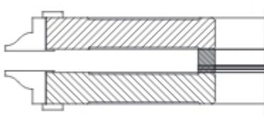
Набор насадных профильных фрезерных головок, типа **GD-01** с четырьмя режущими гранями, предназначены для профессиональной обработки массивной древесины и дерево производных материалов, таких как ДСП, МДФ и подобных. Набор предназначен для фрезерования шипового профиля дверной обвязки. Регулировка осуществляется с помощью прокладок входящих в комплект поставки.
