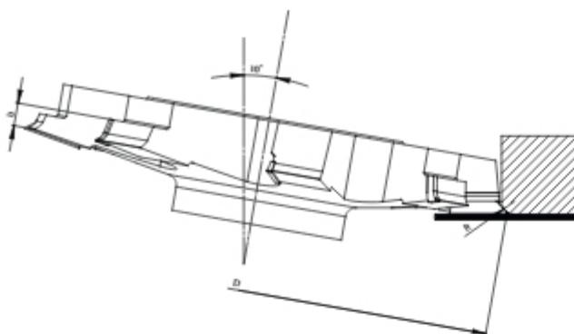
Фреза насадная профильная тип **FPD-300** служит для профилирования поверхности материала для создания постформинг плиты. Фреза предназначена для работы на станках Homag и IMA.
