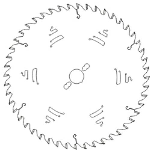
Универсальные пилы из группы PI-504VT Premium – это пилы со средним количеством зубьев, с переменно-косым зубом GS, с напайками из очень твердого спекаемого сплава "T", предназначены для поперечной резки kleеной древесины, фанеры, монолитной древесины, на станках с ЧПУ и станках с ручным управлением.
