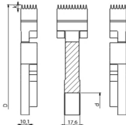
Насадные фрезы для сращивания служат для соединения древесины. Высокая точность изготовления фрез обеспечивает высококачественное стабильное микро-соединение, а малая (4 мм) величина соединения позволяет сэкономить на материале. Фрезы предназначены для соединения легких мебельных элементов малой выносливости, таких как ламели, тонкие листы древесины, деревянные планки к зеркалам, рамкам и др.
