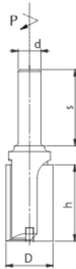
Фреза TW-01-2 – это концевая прямая фреза с количеством зубьев  $z=2$  предназначена для профессиональной обработки дерева и других древесных материалов, таких как ДСП, МДФ и других. Фреза служит для продольной обработки – для форматирования или фальцовки.
