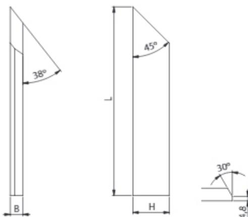
Стружечный нож тип **NOB-01A** предназначен для предварительной черновой обработки древесины. Дополнительная профильная кромка на ноже поправляет качество обработки, а также уменьшает энергоемкость.
