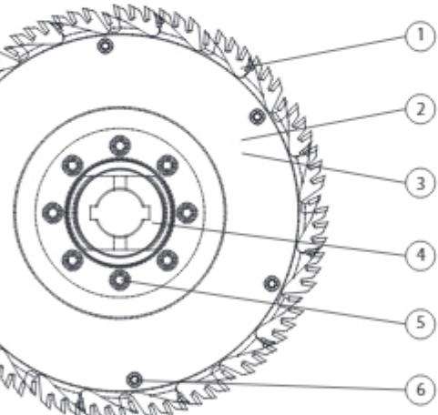
Дробитель **GSZ-03** – это комплектная дробильная фрезерная головка с напайками из очень твердого сплава "Т" предназначена для форматирования и дробления древесины.
