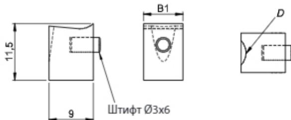
Прижимной клин **KST-01** предназначен для крепления (прижимания) ножа в гнезде фрезерной головки. Прижимной клин оснащен предохранительным штифтом.
