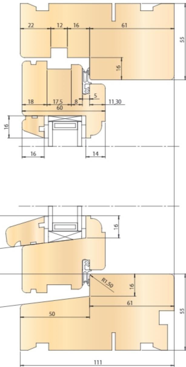
Наборы фрезерных насадных головок, тип GO-16 с тремя режущими гранями для изготовления шипов и проушины, и двумя режущими гранями для продольного профилирования, предназначены для обработки монолитной древесины. Наборы спроектированы для производства окон со стекло пакетом с шириной бруса 111 мм — ФИНСКОГО типа. Комплект состоит из 11 базовых и 5 дополнительных наборов, смонтированных на втулках (буксах) длиной 140 мм для коробки и 90 мм для створки.
