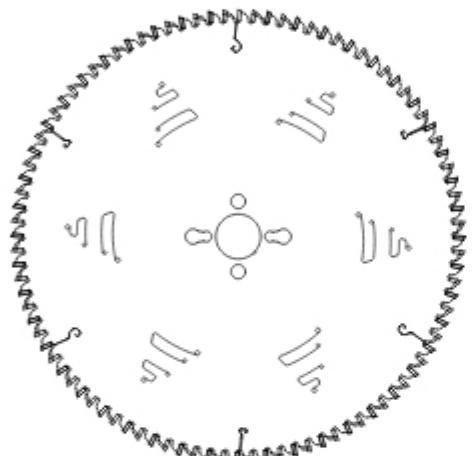
Универсальные пилы из группы PI-512VT – это пилы с переменно-косым зубом с большим углом скоса (GS=38°), с напайками из очень твердого спекаемого сплава "Т", предназначены для очень точной (чистовой) резки под углом древесины и плит MDF без подрезающей пилы. Лазерные насечки на пиле "V" уменьшают шумовую нагрузку на половину.
