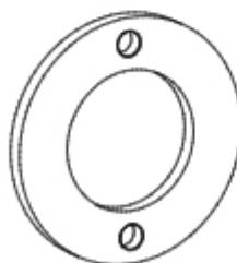
Прокладка **PD-01 с отверстиями**, повышенной твердости, предназначена для фиксации положения инструментов относительно друг друга и регулировки ширины комплектов. Используется для наборов фрез или головок, скручиваемых винтами. Ширина регулируется путем добавления или вычитания соответствующей толщины прокладки.
