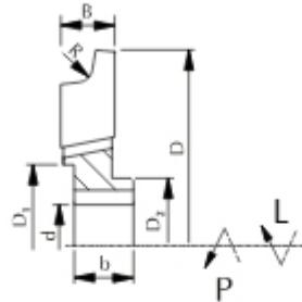
Фреза F56-A 6.1 – это специальная насадная профильная фреза с количеством зубьев  $z=6.1$  предназначена для профессиональной обработки дерева и других древесных материалов, таких как ДСП, МДФ и других. Фреза служит для закругления края доски радиусом согласно заказу. Ось резцов расположена под углом оси инструмента. Это позволяет достичь высокого качества обрабатываемой поверхности.
