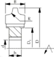
Фреза F56-B 6.0 – это специальная насадная профильная фреза с количеством зубьев  $z=6.0$  предназначена для профессиональной обработки дерева и других древесных материалов, таких как ДСП, МДФ и других. Фреза служит для двустороннего закругления радиусом согласно заказу.
