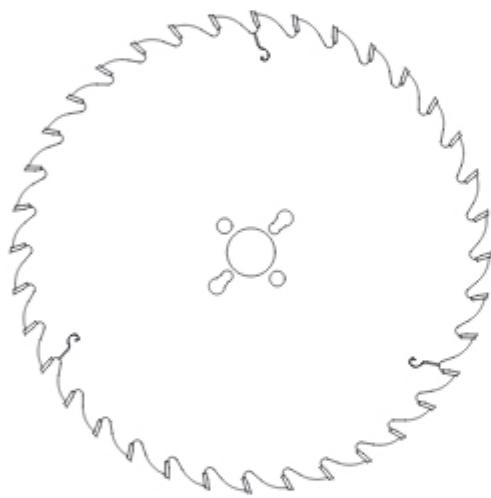
Пилы PI-511 EVO2 предназначены для продольной резки мокрой твердой древесины. Зубья прямые GM. Пилы предназначены для одиночной резки, нельзя использовать на многопильных станках.
