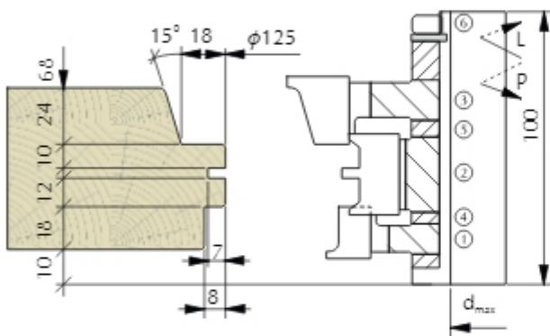
Внутренний продольный профиль нижнего горизонтального бруска коробки (рамы) (собранный на втулке).
