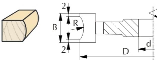
Фреза P-116 4.0 – это насадная профильная фреза с количеством зубьев  $z=4.0$  предназначена для профессиональной обработки дерева и других древесных материалов, таких как ДСП, МДФ и других. Фреза служит для закругления края доски радиусом согласно заказу.
