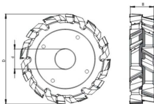
Набор прямых насадных фрез тип **ZFD-002** предназначен для работы на форматно-раскроечном станке.
