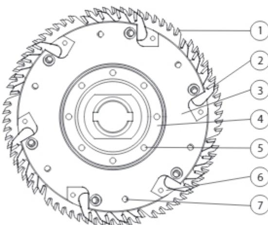
Дробитель **GSZ-01** – это комплектная дробильная фрезерная головка с напайками из очень твердого сплава "Т" предназначена для форматирования и дробления ДСП и МДФ на станках с ЧПУ.
