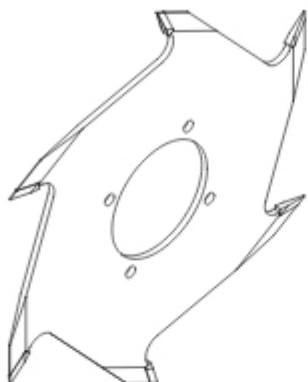
Фрезы для сращивания FZK-30 служат для обработки древесины и kleеного дерева. Конструкция этих фрез позволяет легко соединять их в наборы и обрабатывать материал желаемой ширины. Обеспечивается это за счет ширины деления фрез  $t=3,8$  мм или  $t=4,0$  мм.
