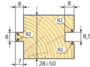
Набор фрез **6200** – это насадные профильные фрезы с количеством зубьев  $z=4.0$  предназначены для профессиональной обработки древесины. Профилюя паз-гребень, служат для изготовления доски пола. С помощью прокладок осуществляется регуляция обрабатываемого материала. Наборы предназначены для двусторонних станков.
