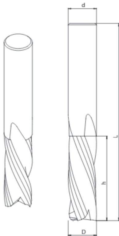
**THM-03 Р и THM-04 L** – это концевые спиральные монолитные фрезы соответственно правого и левого вращения с количеством спиральных зубьев  $z=2$  или  $z=3$  предназначены для профессиональной обработки дерева и других древесных материалов, таких как ДСП, МДФ и других. Фрезы служат для чистовой обработки материала, выборки пазов, нестинга. Специальная геометрия резца в фрезах направляет отвод стружки вниз.
