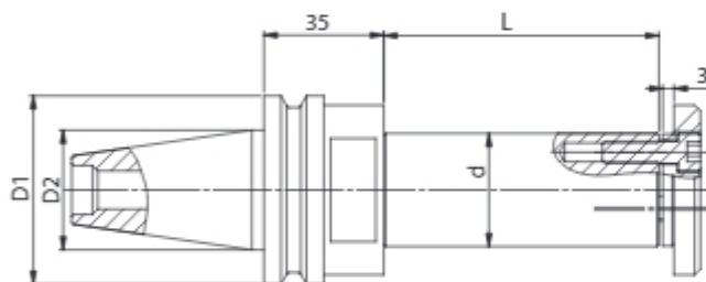
Фрезерная оправка ISO 30 служит для крепления насадных инструментов с посадочным диаметром  $d=30$  или  $d=40$  мм на фрезерных центрах с ЧПУ. Оправка соответствует норме DIN 69871. В оправке предусмотрен шпоночный паз, предохраняющий инструмент от проворачивания. Оправка изготовлена из закаленной стали, отшлифована и сбалансирована.
