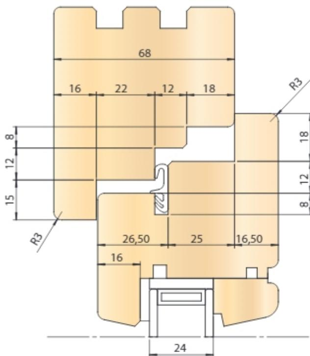
Наборы насадных фрез, типа **ZFO-02**, с четырьмя режущими гранями, предназначены для профессиональной обработки массивной древесины. Наборы предназначены для изготовления окон со стекло пакетом толщиной бруса 68 мм. Комплект состоит из 13 наборов смонтированных на втулках (буксах) длиной 100 мм, без возможности увеличения толщины оконной створки и рамы.
