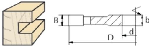
Фреза 3110 8.2 – это насадная прямая фреза с количеством зубьев  $z=8.2$  предназначена для профессиональной обработки дерева и других древесных материалов, таких как ДСП, МДФ и других. Целостная конструкция гарантирует точное позиционирование фрезы на вале станка. Ось резцов – попарно под углом оси инструмента. Это позволяет достичь высокого качества обрабатываемой поверхности. Большее количество зубьев дает возможность работать на высших подачах.
