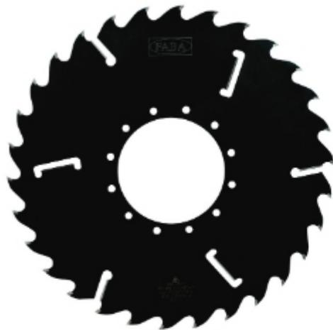
Специальные пилы с прямым зубчатым венцом GM, со специальными напайками из твердого спекаемого сплава или стеллита, предназначены для продольной резки древесины на высокоскоростных автоматических лесопильных центрах HewSaw, Linck, EWD, Heinola, Ari-Vislanda, Söderhamn и др. Пилы оснащены боковыми ножами. Пилы покрыты специальным материалом, который предохраняет от налипания живичных смол и уменьшает силы трения.
