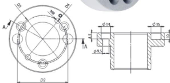
Гидровтулка TKG (на ключ, с резьбой) предназначена для многократного монтажа насадного инструмента. Зажим на валу происходит молниеносно, сразу после нескольких оборотов имбусового ключа.
