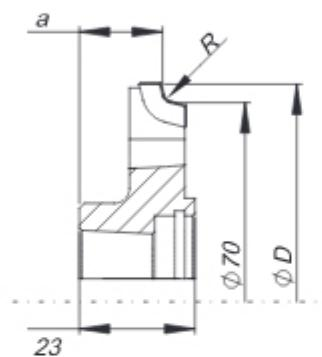
Фреза насадная профильная тип FPD-504 предназначена для обработки кромки.
