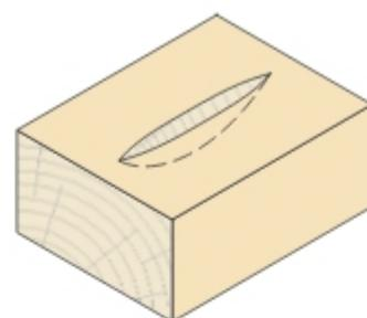
Фреза FL-01 – это специальная насадная профильная фреза с количеством зубьев  $z=4.2$  или  $z=6.2$  предназначена для профессиональной обработки древесины и kleеного дерева. Ось резцов расположена попеременно под углом оси инструмента. Это позволяет достичь высокого качества обрабатываемой поверхности. Фреза предназначена для выборки живичного паза для соединения с помощью шпонки, для угловых и продольных соединений.
