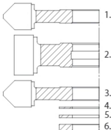
Набор фрез FP-16 – это насадные профильные фрезы с количеством зубьев  $z=4.0$  или  $z=6.0$  предназначены для профессиональной обработки дерева и других древесных материалов, таких как ДСП, МДФ и других. Служат для создания фасок в материале. С помощью прокладок осуществляется регуляция ширины обрабатываемого материала.
