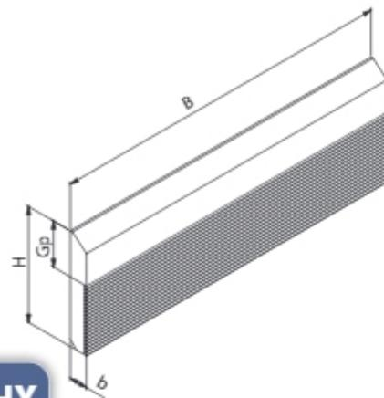
Ножи GP-01 или GP-03 – это бланкетные ножи с одной режущей кромкой предназначены для профессиональной обработки древесины. Ножи служат для обработки плоских поверхностей, а также для профилирования поверхности в материале. Регулировка высоты ножей осуществляется методом их точного блокирования и зажима в гнезде. Ножи изготавливаются также в версии с покрытием HP или NX.
