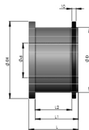
Гидровтулки **THL** и **THLG** (на насос) предназначены для многократного монтажа насадного инструмента.
