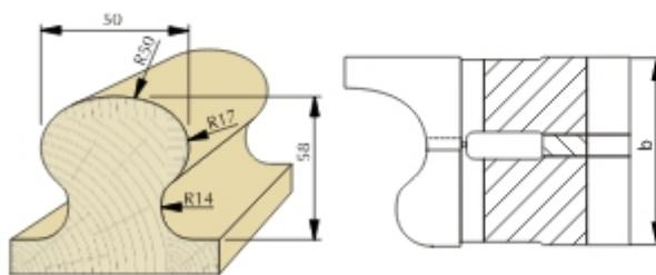
Набор фрез FP-14 – это насадные профильные фрезы с количеством зубьев  $z=3.0$  предназначены для профессиональной обработки древесины. Служат для профилирования перил.
