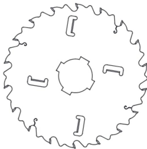
Пилы из группы PI-502 EVO2 – это пилы с ограничителем подачи, с прямым зубом GM, с двумя открытыми (+2) либо с двумя открытыми и двумя закрытыми (+4) боковыми зубьями, предназначены для работы на многопильных станках, для продольной резки сухой мягкой или твердой монолитной древесины.
