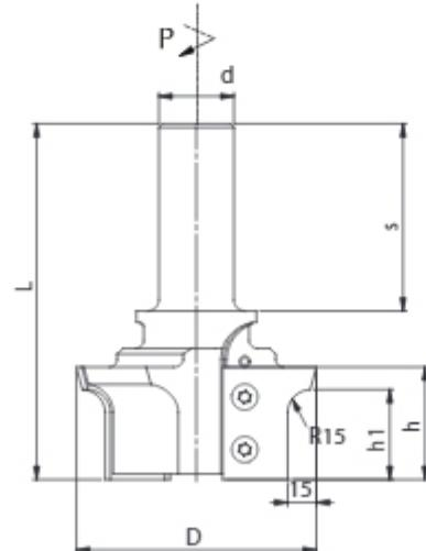
Головка FTS-10 служит для продольной профильной обработки поверхности без возможности сверления.
