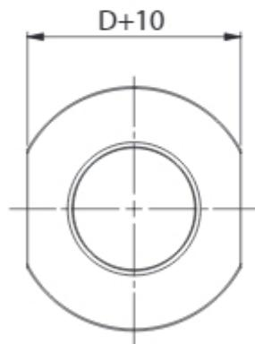
Втулка для окон тип **GO** – это специальная втулка предназначена для монтажа наборов насадных фрез или фрезерных головок для изготовления окон, а также для монтажа других насадных фрезерных наборов. Специальная конструкция втулки предохраняет от самопроизвольного раскручивания прижимной гайки во время работы. В комплект набора входят втулка, прижимная гайка и специальная прокладка.
