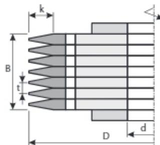
Фрезы FZK-30 Plus служат для сращивания древесины и kleеного дерева. Благодаря конструктивным и технологическим изменениям фрезы FZK-30 Plus обеспечивают качественное соединение даже после многоразового затачивания. Повысилась также в 3 раза износостойкость фрез по сравнению с фрезами FZK-30 (при обработке твердого дерева).
