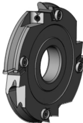
Фрезерная профильная головка **GPF-01** – это насадная профильная головка со сменными пластинами с тремя или четырьмя зубьями, предназначена для профессиональной обработки древесины, а также ДСП, МДФ и других древесных материалов. Головка GPF-01 разработана с осевым углом 5 ° для точного профилирования мебельных фронтов.
