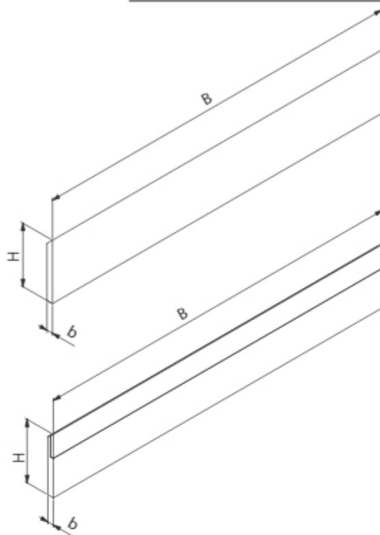
Ножи 1100-4 – это строгальные ножи с одной режущей кромкой предназначены для профессиональной обработки древесины. Применяются в головках 1100-4 и 1100-5. Ножи служат для обработки плоских поверхностей.
