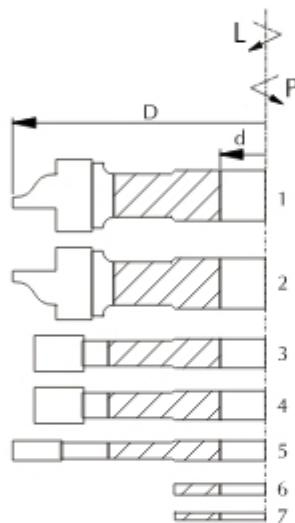
Набор фрез FP-10 – это насадные профильные фрезы с количеством зубьев  $z=4.0$  предназначены для профессиональной обработки дерева и других древесных материалов, таких как ДСП, МДФ и других. Служат для профилирования односторонних мебельных дверей. С помощью прокладок осуществляется регуляция обрабатываемого материала. Одним набором можно создать несколько профилей.
