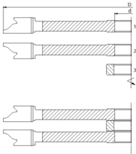
Набор насадных профильных фрез, типа **IL-M.00** с четырьмя режущими гранями, предназначены для профессиональной обработки массивной древесины и дерево производных материалов, таких как ДСП, МДФ и подобных. Набор предназначен для фрезерования шипового профиля дверной обвязки.
