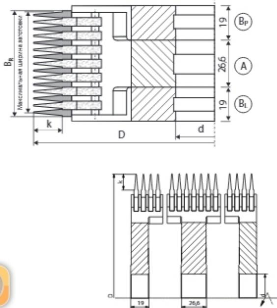
Набор фрез FZK-17A/17B характеризуется повышенной производительностью за счет того, что имеет удвоенное количество зубьев (фактически  $z=6$ ). Минимальный набор состоит из одной фрезы FZK-17A, размещенной по средине, и двух боковых фрез FZK-17B. Для увеличения ширины обрабатываемого материала достаточно будет только добавлять центральные фрезы FZK-17A. Набор фрез выпускается только для станков с форматированием / подрезанием (FZK-17A/17B, 15/16,5).
