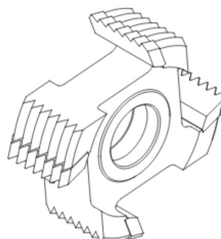
При заказе фрез FZK укажите обрабатываемый материал, тип соединения (поперечное или продольное) и способ сжатия (ручное или механическое).
