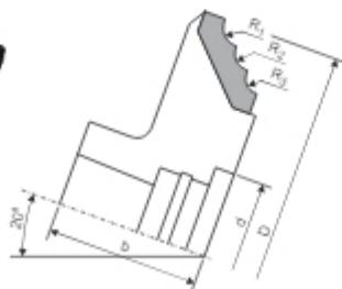
Фреза насадная профильная тип FPD-550 предназначена для профилирования кромок в материале.
