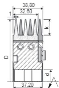
Насадные фрезерные головки GZK-19/20 со сменными пластинами для сращивания служат для соединения древесины. Высокая точность изготовления фрезерных головок обеспечивает высококачественное стабильное соединение. Инструмент выпускается в двух версиях – для станков с форматированием / подрезанием (GZK-20N, 20/22) и для станков без форматирования / подрезания (GZK-19N, 20/20).
