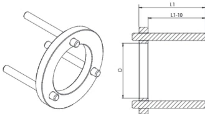
Стопорное кольцо предназначено для гидровтулок TK, TKG, TH, THG, а также гидроголовок 1100-04 H, 1100-05 H, GP-01 H и предохраняет инструмент от проворачивания на вале станка. При заказе стопорного кольца нужно указать посадочный диаметр вала станка d.
