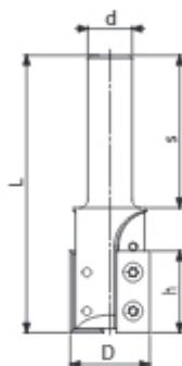
**FTS-07.01** – это концевая прямая фрезерная головка со сменными пластинами с соответствующим количеством зубьев предназначена для профессиональной обработки дерева и других древесных материалов, таких как ДСП, МДФ и других. Головка служит для форматирования и фальцовки.
