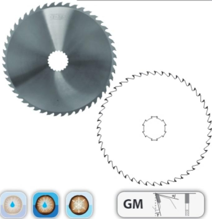
Пилы из группы Spline & CanDrive – это специальные пилы с посадочным отверстием Spline & CanDrive с прямым зубчатым венцом GM или с переменно-косым зубчатым венцом GS, со специальными напайками из твердого спекаемого сплава или стеллита, предназначены для резки свежей древесины (мокрой или мерзлой). Для предварительного разрезания, для обеспечения оптимальной работы пилы оснащены стружко-ламателями.
