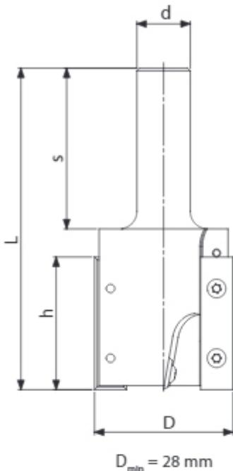
**FTS-07.03** – это концевая прямая фрезерная головка со сменными пластинами с количеством зубьев  $z=2+1$  (два основных зуба + один сверлящий) предназначена для профессиональной обработки дерева и других древесных материалов, таких как ДСП, МДФ и других. Головка служит для выборки пазов, фальцовки, а также для глухого сверления.
