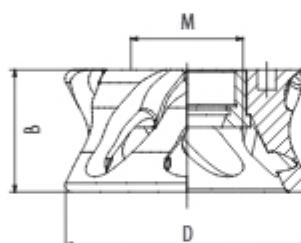
**Торнадо** - это спиральная система отвода стружки из зоны обработки. Работает с оправками HSK 50F, HSK 63F и ISO 30, обеспечивая эффективное удаление стружки, безупречную точность обработки и значительное снижение шума при работе всей системы. Корпус выполнен из легких и прочных материалов. Заменяется стандартную гайку. Рекомендуется для фрезерования и nestinga
