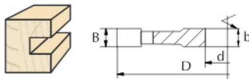
Фреза 3110 12.2 – это насадная прямая фреза с количеством зубьев  $z=12.2$  предназначена для профессиональной обработки дерева и других древесных материалов, таких как ДСП, МДФ и других. Целостная конструкция гарантирует точное позиционирование фрезы на вале станка. Ось резцов – попарно под углом оси инструмента. Это позволяет достичь высокого качества обрабатываемой поверхности. Большее количество зубьев дает возможность работать на высших подачах.
