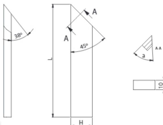
Стружечный нож тип **NOB-01B** предназначен для предварительной черновой обработки древесины. Специальная геометрия резца увеличивает работоспособность и эффективность ножа.
