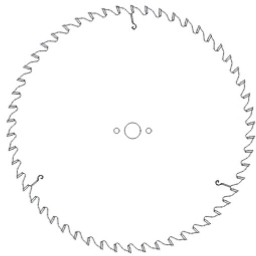
Пилы из группы PI-504V – это пилы со средним количеством зубьев, с переменно-косым зубом GS, предназначены для поперечной резки клееной древесины, сухой мягкой или твердой монолитной древесины на станках с ЧПУ и станках с ручным управлением.
