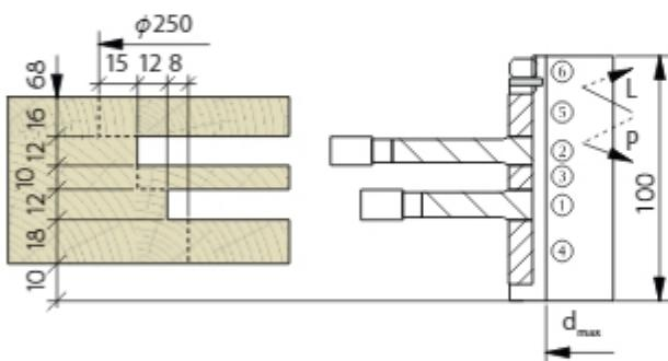
Проушины горизонтальных брусков коробки (рамы) (собранный на втулке).
