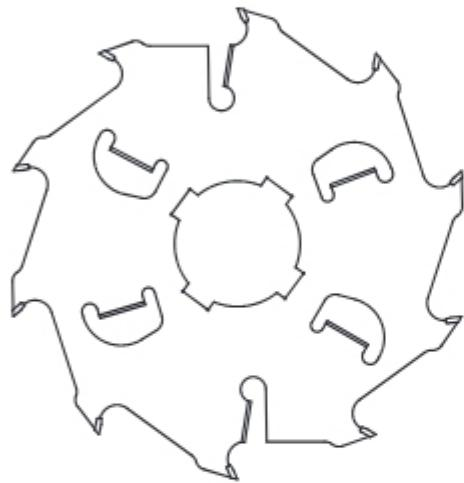
Пилы из группы PI-515 EVO2 – это усовершенствованные пилы с прямым зубом GM или с переменно-косым зубом GS, которые предназначены для работы на многогильных станках при малых скоростях подачи (до 10 м/мин). Пилы служат для продольной резки влажной хвойной или другой мягкой древесины.
