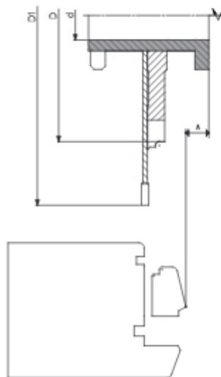
Наборы инструмента с оптимально подобранным количеством режущих граней, предназначены для одновременного профилирования и отрезки штапика. Набор применяется как дополнительный — отрезной, когда продольный внутренний профиль оконной створки изготавливается одновременно с профилем штапика. Набор состоит из фрезы или фрезерной головки со сменными ножевыми пластинами (HSS или HM) и отрезной пилы (HM).
