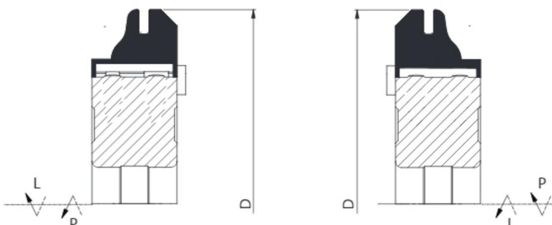
Фрезерная головка 1100-1 со сменными режущими пластинами – это насадная головка с соответствующим количеством зубьев предназначена для профессиональной обработки дерева и других древесных материалов, таких как ДСП, МДФ и других. Головка применяется для обработки плоских поверхностей. Корпус головки может быть как стальной, так и алюминиевый.
