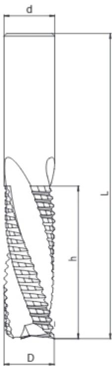
**THM-06** – это концевая спиральная монолитная фреза правого вращения с количеством спиральных зубьев  $z=2$  или  $z=3$  предназначена для профессиональной обработки дерева и других древесных материалов, таких как ДСП, МДФ и других. Фреза служит для предварительного (чернового) форматирования материала, выборки пазов. Специальная геометрия резца направляет отвод стружки вверх. Фреза приспособлена к повышенным параметрам обработки.
