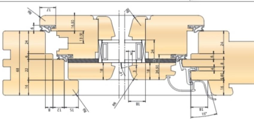
Универсальная система GOD 3U для производства окон 88/92/98 с тремя рядами уплотнителя, один из которых предлагается как опция, на внутренней кромке оконной створки. Система спроектирована таким образом, что при незначительных финансовых инвестициях, простым и быстрым способом (до укомплектации наборов фрезерных головок собранных на втулках), с легкостью возможно наладить производство окон с шириной профиля 88, 92 и 98 мм.
