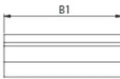
Прижимной клин **KST-02** предназначен для крепления (прижимания) ножа в гнезде фрезерной головки. Служит для крепления ножей типа 1100-4 и 1100-4Н.
