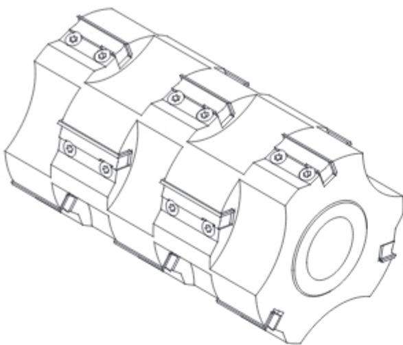
Фрезерная головка 1100-14 – это насадная прямая головка с монолитным корпусом со сменными режущими пластинами с соответствующим количеством зубьев предназначена для профессиональной обработки древесины. Головка служит для предварительной (черновой) обработки плоских поверхностей. Основной размер режущей пластины – 50x12x1,5. Для увеличения диапазона обрабатываемой ширины применяются также пластины размером 40x12x1,5 и 60x12x1,5. Корпус головки может быть как стальной, так и алюминиевый.
