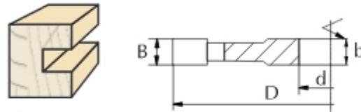
Фреза 3110 4.0 – это насадная прямая фреза с количеством зубьев  $z=4.0$  предназначена для профессиональной обработки дерева и других древесных материалов, таких как ДСП, МДФ и других. Целостная конструкция гарантирует точное позиционирование фрезы на вале станка. Ось резцов – параллельна оси инструмента.
