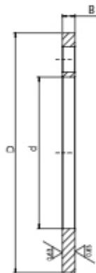
Прокладка с повышенной точностью исполнения предназначена для гидровтулок TK, TKG, TH, THG. Прокладка служит для позиционирования инструмента, а также для заполнения пустого места на втулке.
