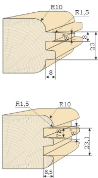
Набор фрез FPO-02 – это насадные профильные фрезы с количеством зубьев  $z=4.0$  предназначены для профессиональной обработки древесины. Служат для изготовления деревянных стен. С помощью прокладок осуществляется регуляция ширины обрабатываемого материала.
