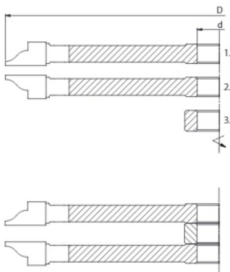
Набор насадных профильных фрез, типа **IL-A.00** с четырьмя режущими гранями, предназначены для профессиональной обработки массивной древесины и дерево производных материалов, таких как ДСП, МДФ и подобных. Наборы предназначены для фрезерования шипового профиля дверной обвязки.
