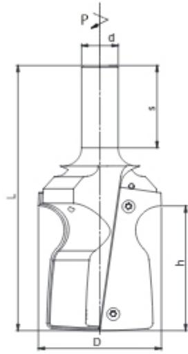
Головка FTS-01 служит для продольной профильной обработки поверхности, а также для глухого сверления.
