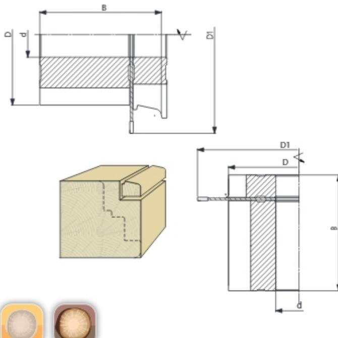
Наборы инструмента с оптимально подобранным количеством режущих граней, предназначены для одновременного профилирования и отрезки штапика, а также вступительного профилирования оконной рамы. Набор состоит из фрезы или фрезерной головки со сменными ножевыми пластинами (HSS или HM) и отрезной пилы (HM). Наборы производятся по индивидуальным заказам.
