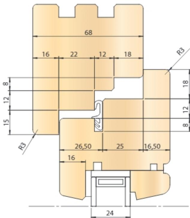
Наборы насадных фрезерных головок, тип **GO-01**, с тремя режущими гранями для изготовления шипов и проушин, и двумя режущими гранями для продольного профилирования, предназначены для профессиональной обработки массивной древесины. Наборы предназначены для изготовления окон со стекло пакетом с толщиной бруса 68 мм. Комплект состоит из 11 базовых и 5 дополнительных наборов смонтированных на втулках (буксах) длиной 100 мм.
