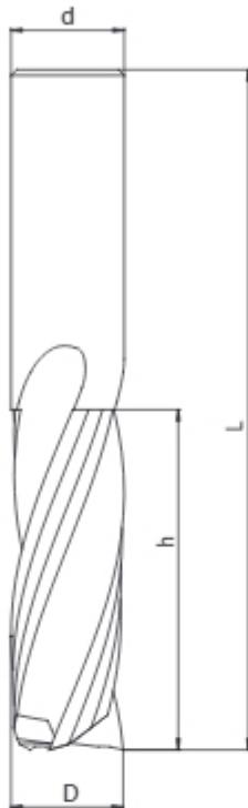
**THM-01** – это концевая спиральная монолитная фреза правого вращения с количеством спиральных зубьев  $z=2$  или  $z=3$  предназначена для профессиональной обработки дерева и других древесных материалов, таких как ДСП, МДФ и других. Фреза служит для чистового форматирования материала, выборки пазов, нестинга. Специальная геометрия резца направляет отвод стружки вверх.
