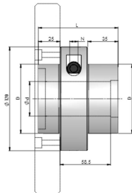
Гидровтулка Т12 предназначена для высокоточного монтажа насадного инструмента. Инструмент насаживается на высокоточную поверхность втулки. Существует возможность последовательного размещения нескольких насадных инструментов на втулке одновременно. Зажим гидровтулки за счет проворачивания винта. Гидровтулка приспособлена также для монтажа на шестигранный вал станка. Гидросистема в этом типе втулок более эффективная и устойчивая.
