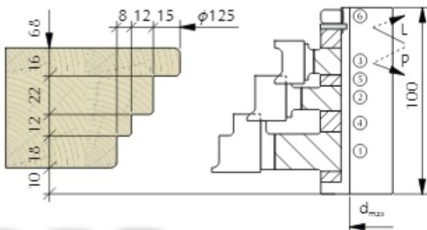
Внутренний продольный профиль верхнего и боковых брусков коробки (рамы) (собранный на втулке).
