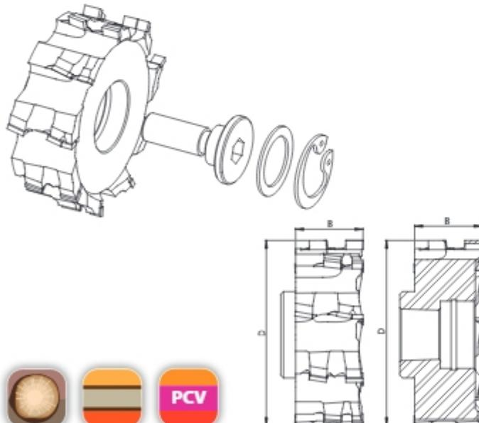
Фреза насадная профильная тип **FD-500** предназначена для профилирования материала.
