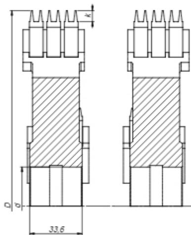
Фреза FZK-23N предназначена для клиновых соединений массива мягкого дерева. Уникальная точность инструмента на микро-клинья позволяет создавать идеально подобранные элементы, а маленькая высота соединения 6/7 гарантирует экономию материала. Инструмент предназначен для соединения лёгких элементов, для изготовления картичных рамок, зеркальных панелей и элементов мебели малой прочности. Складывание нескольких инструментов в набор позволяет получить желаемую высоту обрабатываемого материала.
