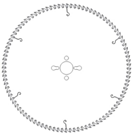
Пилы из группы **PI-531** – это пилы с большим количеством зубьев, с трапецидально-прямым зубчатым венцом GA с положительным углом атаки, со специальными напайками из твердого спекаемого сплава, предназначены для точной резки выполненных объемно материалов (пруток) из алюминия, легких сплавов и пластмасс на станках с механической подачей.
