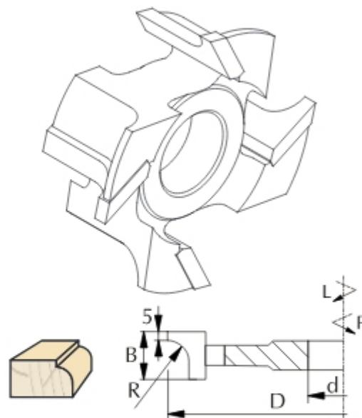
Вид обработки: двустороннее закругление кромок.
