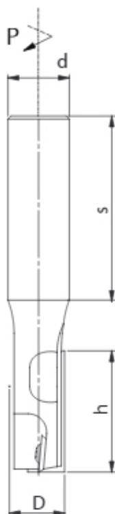
FTS-03 – это концевая прямая фрезерная головка со сменными пластинами с количеством зубьев  $z=1+1$  (один зуб основной и один зуб направляющий) предназначена для профессиональной обработки дерева и других древесных материалов, таких как ДСП, МДФ и других. Головка служит для выборки пазов, фальцовки, а также для глухого сверления. Внутренний (направляющий) зуб головки ответственный за углубление в материале, а внешний (основной) за создание паза соответствующей ширины.
