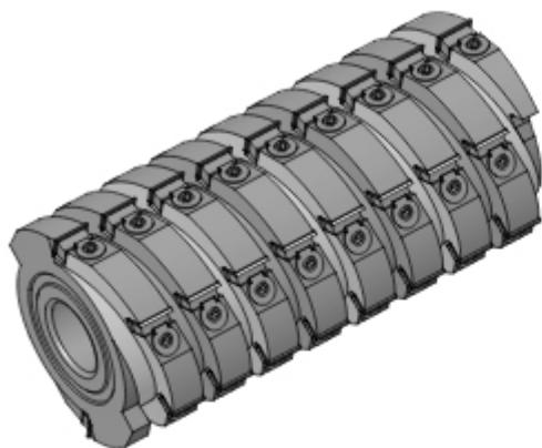
Фрезерная головка **G1115** – это насадная спиральная головка со сменными режущими пластинами с увеличенным количеством зубьев предназначена для профессиональной обработки дерева и других древесных материалов, таких как ДСП, МДФ и других. Головка служит для предварительной (черновой) обработки плоских поверхностей материала с разным направлением волокон. Головка приспособлена для снятия неровностей в материале высотой до 8 мм. Корпус головки может быть как стальной, так и алюминиевый.
