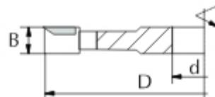
Фреза 3110-2 – это насадная прямая фреза с количеством зубьев  $z=2$  v2 или  $z=4$  v4, то есть с 2 (4) режущими зубьями и с 2 (4) подрезающими зубьями с правой или левой стороны для прецизионной фальцовки. Фреза предназначена для профессиональной обработки дерева и других древесных материалов, таких как ДСП, МДФ и других. Целостная конструкция гарантирует точное позиционирование фрезы на вале станка.
