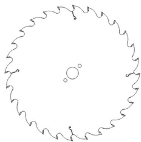
Пилы PI-501 EVO2 предназначены для продольной резки сухой (мягкой и твердой) древесины. Зубья прямые GM. Пилы предназначены для одиночной резки, нельзя использовать на многопильных станках. Пилы покрыты специальным материалом, который предохраняет тело пилы от налипания живичных смол и уменьшает силы трения.
