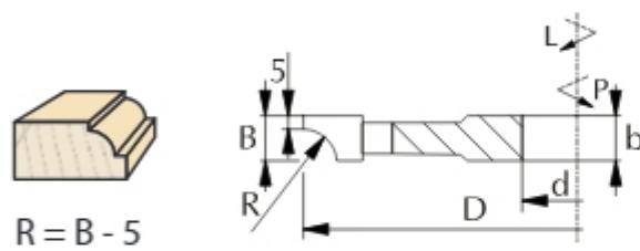
Фреза P-101 4.0 – это насадная профильная фреза с количеством зубьев  $z=4.0$  предназначена для профессиональной обработки дерева и других древесных материалов, таких как ДСП, МДФ и других. Фреза служит для фрезерования четверти паза радиусом равным ширине фрезы, уменьшенным на 5 мм.
