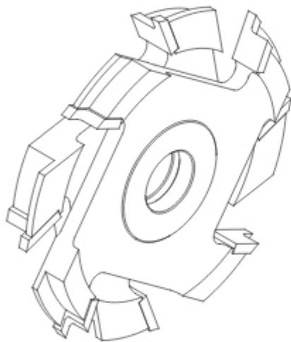
Набор фрез 7311 – это насадные профильные фрезы с количеством зубьев  $z=6.0$  предназначены для профессиональной обработки древесины. Профилируя паз-гребень, служат для изготовления паркета. С помощью прокладок осуществляется регуляция обрабатываемого материала. Наборы предназначены для двусторонних станков.
