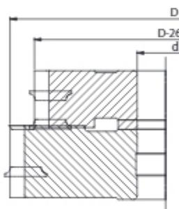
Набор насадных профильных фрезерных головок, типа **GD-10** с количеством режущих граней подобранным в соответствии с определенными параметрами, предназначен для профессиональной обработки массивной древесины и дерево производных материалов, таких как ДСП, МДФ и подобных. Набор предназначен для фрезерования наружного продольного притворного профиля стояков и перемычек дверного полотна. Регулировка осуществляется с помощью прокладок входящих в комплект поставки.
