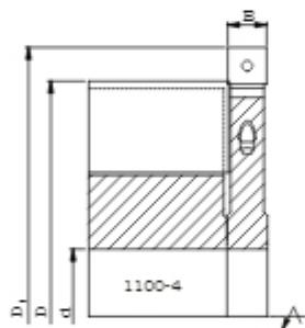
Фрезерная головка **G103** – это насадная прямая головка со сменными режущими пластинами с двумя прямыми резцами и двумя подрезными, левыми или правыми ( $z=2v2$ ), предназначена для профессиональной обработки древесины. Головка служит для форматирования торца обрабатываемого материала. Специальная геометрия позволяет применять ее в комплекте вместе с прямыми головками 1100-4. Корпус головки может быть как стальной, так и алюминиевый.
