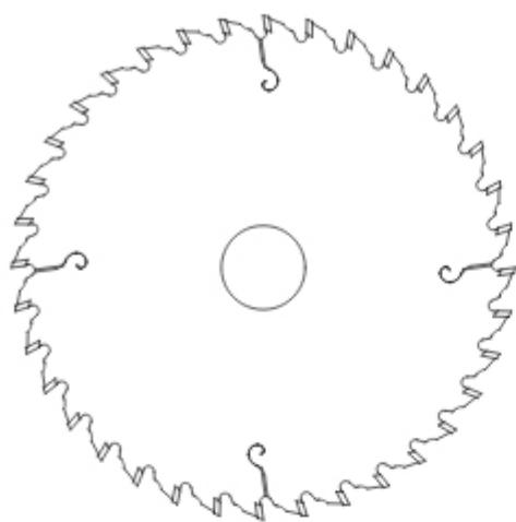
Алмазная подрезная пила тип PD-408 – это пила с резцами из поликристаллического алмаза (PCD) с трапециoidalным зубчатым венцом (GR/GM, GR/GS), предназначена для резки однородных, без загрязнений, материалов на автоматических и ручных обрабатывающих линиях.
