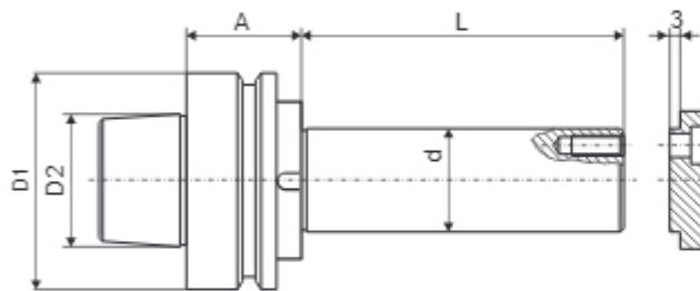
Фрезерные оправки **HSK 63F** служат для крепления насадных инструментов с посадочным диаметром  $d=30$  или  $d=40$  мм на фрезерных центрах с ЧПУ. Оправки соответствуют норме DIN 69893. В оправках предусмотрен шпоночный паз, предохраняющий инструмент от проворачивания. Оправки изготовлены из закаленной стали, отшлифованы и сбалансированы.
