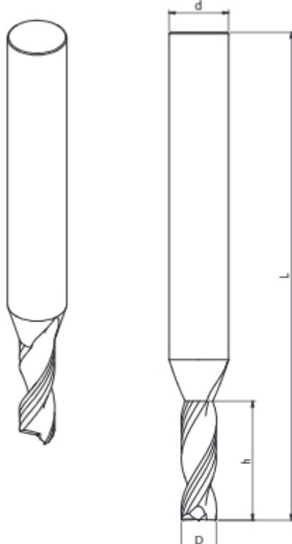
**THM-15 Р и THM-16 L** – это концевые спиральные монолитные фрезы соответственно правого и левого вращения с количеством спиральных зубьев  $z=2$  или  $z=3$  предназначены для профессиональной обработки дерева и других древесных материалов, таких как ДСП, МДФ и других. Фрезы служат для чистового формирования материала, выборки пазов, нестинга. Специальная геометрия резца направляет отвод стружки вверх. Конструкция фрез характеризуется утолщенным хвостовиком.
