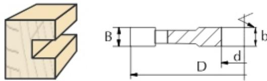
Фреза 3110 6.2 – это насадная прямая фреза с количеством зубьев  $z=6.2$  предназначена для профессиональной обработки дерева и других древесных материалов, таких как ДСП, МДФ и других. Целостная конструкция гарантирует точное позиционирование фрезы на вале станка. Ось резцов – попеременно под углом оси инструмента. Это позволяет достичь высокого качества обрабатываемой поверхности.
