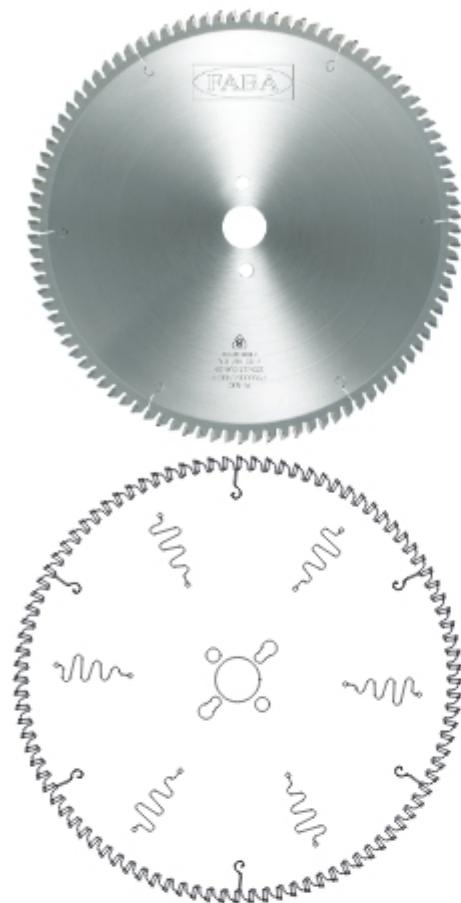
Пилы из группы PI-530 – это пилы со средним и большим количеством зубьев, с трапецидально-прямым зубчатым венцом GA с негативным углом атаки, со специальными напайками из твердого спекаемого сплава, предназначены для точной резки профилей из алюминия, легких сплавов и пластмасс на станках с ЧПУ и станках с ручным управлением.
