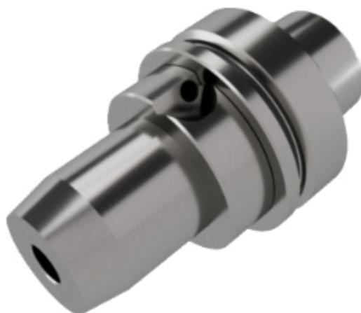
Гидро-зажимная оправка HSK63F предназначена для точного многократного крепления концевых инструментов с цилиндрическим хвостовиком. Зажим инструмента в держателе происходит очень быстро, после нескольких оборотов шестигранного ключа.
