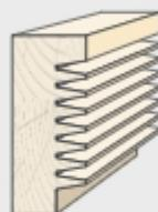
Набор фрез для мини-соединений тип ZZK-06 с регуляцией ширины соединения с глубоким профилем обработки (12 мм, шаг 7 мм), с целью повышения прочности соединения, предназначен для продольного и поперечного сращивания древесины.
