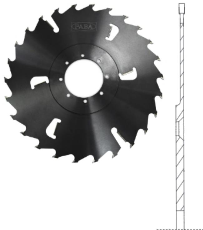
Делительные пилы на многопильные станки – это специальные пилы с прямым зубчатым венцом GM, со специальными напайками из твердого спекаемого сплава или стеллита, предназначены для продольной резки древесины на высокоскоростных автоматических лесопильных центрах. Пилы оснащены боковыми ножами.
