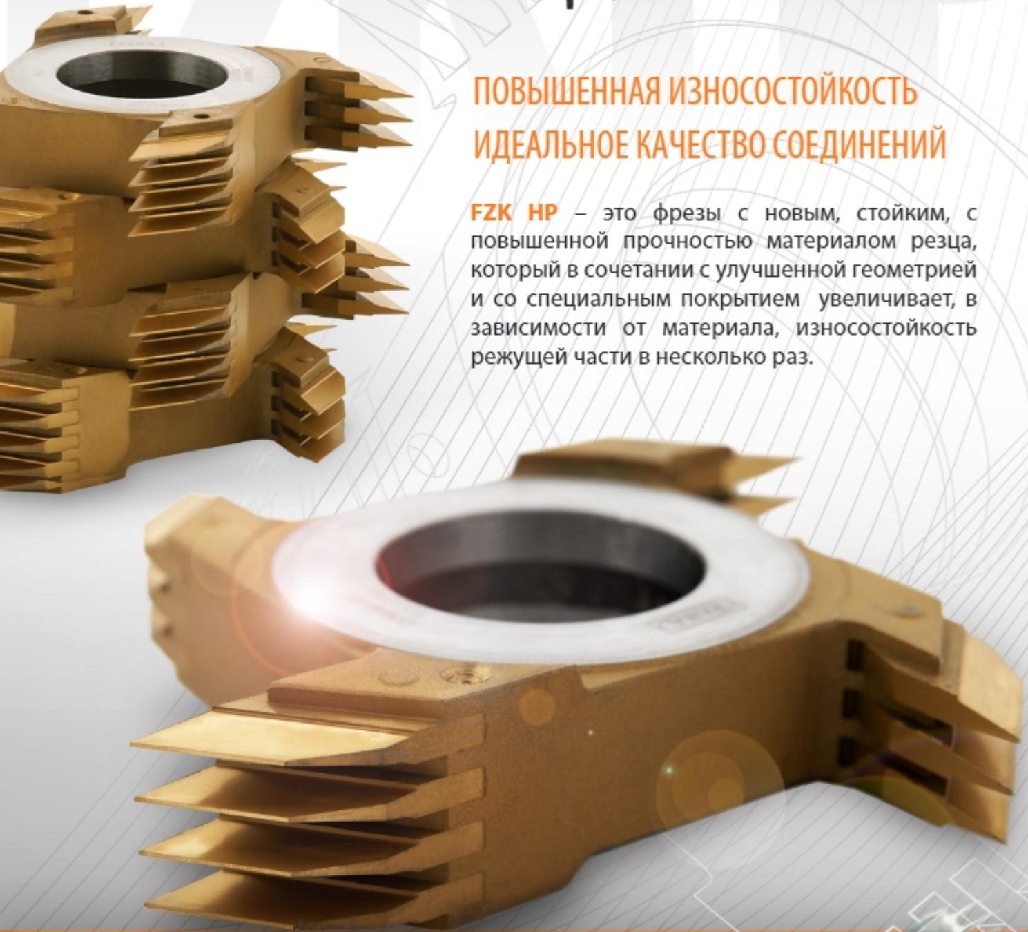
Достигается это, благодаря новому технологическому процессу тепловой обработки быстрорежущей стали, а также благодаря обволакиванию поверхности резцов специальным покрытием из химических элементов и их соединений. В результате многократно повышается износостойкость инструмента и достигается оптимальная прочность резца, что приводит к идеальному качеству клиновых соединений, а также к уменьшению количества заточек.
