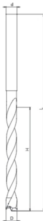
Глухие монолитные сверла с повышенной износостойкостью, тип **WN-46**, предназначены для профессиональной обработки дерева, ДСП, МДФ, ламинированных и других древесных плит. Сверла характеризуются одинаковым диаметром рабочей части и хвостовика.
