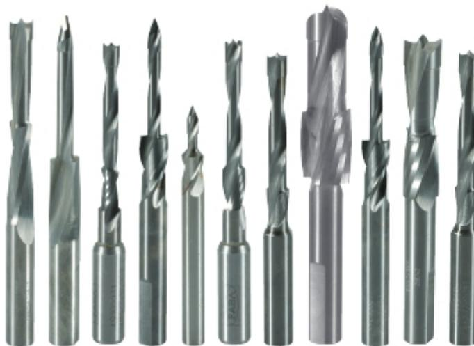
Монолитные ступенчатые сверла с повышенной износостойкостью, глухие тип **WN-48**, **WP-48**, и сквозные тип **WN-42**, **WP-42**, предназначены для профессиональной обработки дерева, ДСП, МДФ, ламинированных и других древесных плит. Специальная конструкция сверла позволяет на высококачественное высверливание комбинированных отверстий без применения зенковки.
