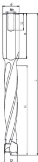
Сверла глухие с напайкой HM, с двойной спиральной линией, тип WN-07, предназначены для профессиональной обработки дерева, ДСП, MDF, ламинированных и других древесных плит.
