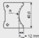
Максимальная глубина профиля режущей пластины для ширины 60 мм и 40 мм
