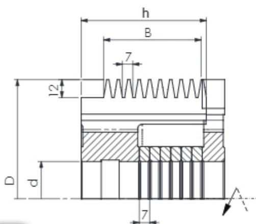
Набор фрез для мини-соединений тип **ZZK-06** с регулировкой ширины соединения с глубоким профилем обработки (12 мм, шаг 7 мм), с целью повышения прочности соединения, предназначен для продольного и поперечного сращивания древесины.
