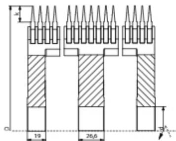
Набор фрез **FZK-17A/17B** характеризуется повышенной производительностью за счет того, что имеет удвоенное количество зубьев (фактически  $z=6$ ). Минимальный набор состоит из одной фрезы FZK-17A, размещенной по середине, и двух боковых фрез FZK-17B. Для увеличения ширины обрабатываемого материала достаточно будет только добавлять центральные фрезы FZK-17A. Набор фрез выпускается только для станков с форматированием / подрезанием (FZK-17A/17B, 15/16,5).
