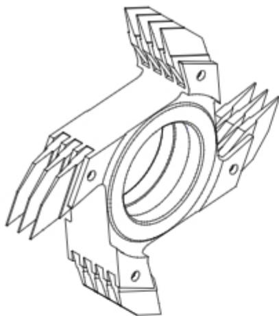
Насадные фрезы для сращивания **FZK-17N/18N** служат для соединения древесины. Высокая точность изготовления фрез обеспечивает высококачественное стабильное соединение. Фрезы выпускаются в двух версиях – для станков с форматированием / подрезанием (FZK-17N, 15/16,5) и для станков без форматирования / подрезания (FZK-18N, 15/15).
