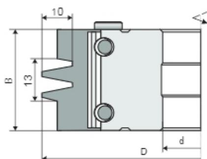
Фрезерная головка для клиновых соединений **GZK-07** с возможностью регулирования силы сжатия соединения. Перемещение с помощью регулятора передвижной базы позволяет настроить силу сжатия соединения в зависимости от вида обрабатываемого материала, технического состояния станка и в зависимости от силы сжатия. При запросе на, желание клиента в зависимости от ширины обрабатываемого материала, количество клиновых шипов показанных на рисунке, может быть изменено.
