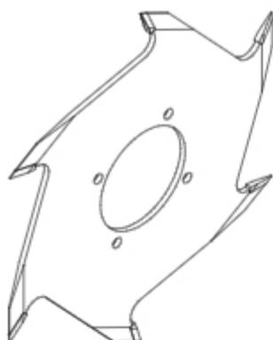
Фрезы для сращивания **FZK-30** служат для обработки древесины и клееного дерева. Конструкция этих фрез позволяет легко соединять их в наборы и обрабатывать материал желаемой ширины. Обеспечивается это за счет ширины деления фрез  $t=3,8$  мм или  $t=4,0$  мм.
