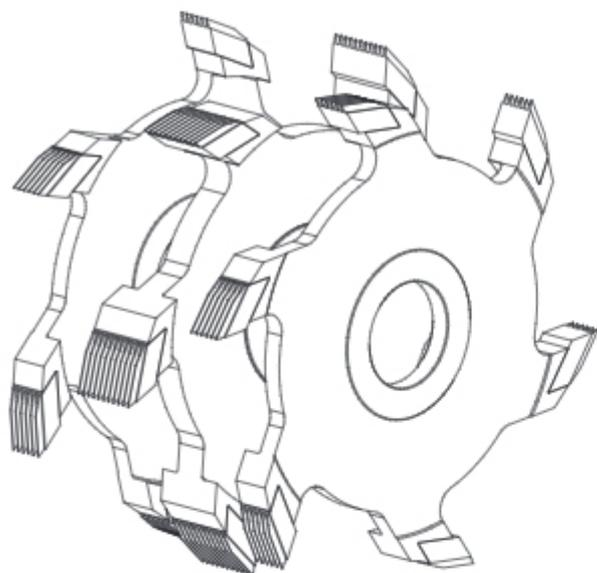
Насадные фрезы для сращивания служат для соединения древесины. Высокая точность изготовления фрез обеспечивает высококачественное стабильное микро-соединение, а малая (4 мм) величина соединения позволяет сэкономить на материале. Фрезы предназначены для соединения легких мебельных элементов малой выносливости, таких как ламели, тонкие листы древесины, деревянные планки к зеркалам, рамкам и др.
