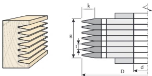
Фрезы **FZK-30 Plus** служат для сращивания древесины и клееного дерева. Благодаря конструктивным и технологическим изменениям фрезы FZK-30 Plus обеспечивают качественное соединение даже после многократного затачивания. Повысилась также в 3 раза износостойкость фрез по сравнению с фрезами FZK-30 (при обработке твердого дерева).
