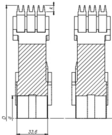
Фреза **FZK-23N** предназначена для клиновых соединений массива мягкого дерева. Уникальная точность инструмента на микро-клинья позволяет создавать **идеально подобранные элементы**, а маленькая высота соединения 6/7 гарантирует экономию материала. Инструмент предназначен для соединения лёгких элементов, для изготовления картинных рамок, зеркальных панелей и элементов мебели малой прочности. Складывание нескольких инструментов в набор позволяет получить желаемую высоту обрабатываемого материала.
