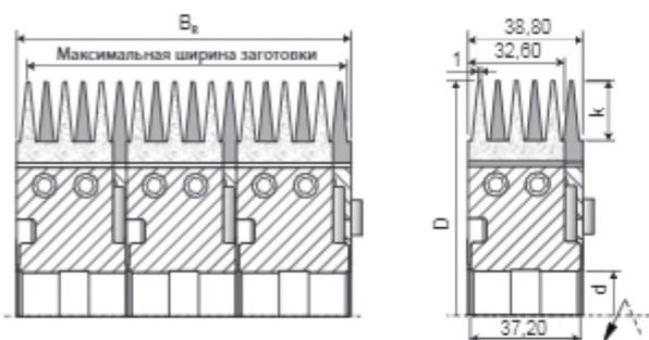
Насадные фрезерные головки **GZK-19/20** со сменными пластинами для сращивания служат для соединения древесины. Высокая точность изготовления фрезерных головок обеспечивает высококачественное стабильное соединение. Инструмент выпускаются в двух версиях – для станков с форматированием / подрезанием (GZK-20N, 20/22) и для станков без форматирования / подрезания (GZK-19N, 20/20).
